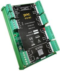
Vollständig mit DIN-Halterung für Befestigung in DIN-Montagegehäusen von PAC (p/n 10031 und 10032)
