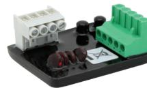
Der Leitungstreiber wird zum Verbinden eines PAC 512 Türzutrittskontrollers mit dem PC, auf dem die PAC Access Central oder EasiNet Residential Software ausgeführt wird
