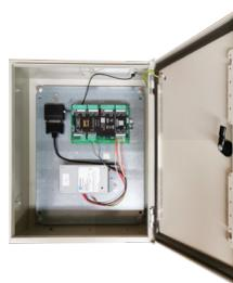
In Sarel-Schalt-schrank, vollständig mit GSM-Modem und kleiner Antenne
