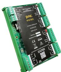
Vollständig mit DIN-Halterung für Befestigung in DIN-Montagegehäusen von PAC (Teilenummer 10031 und 10032)
