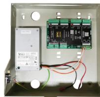
Vollständig mit Metallgehäuse, Schloss, Kontaktschalter und 3 Amp-PSU
